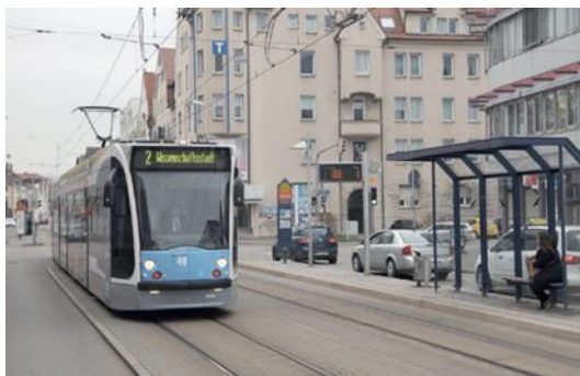
Вид спереди Ulmer StraBenbahn с корпусом для «сцепки», напечатанным на 3D-принтере
