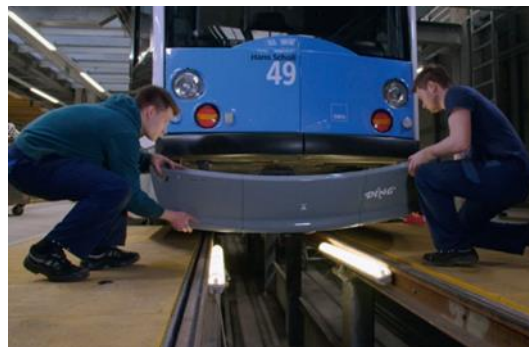
Установка крышки корпуса, напечатанной на 3D-принтере
