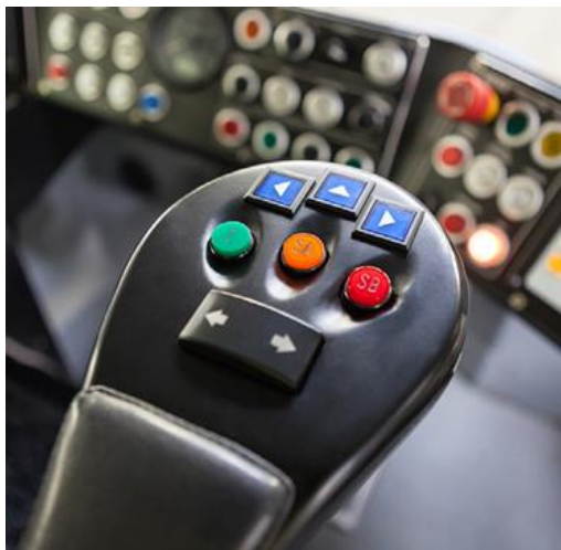
Напечатанный 3D-системой подлокотник с тремя дополнительными кнопками системы контроля
