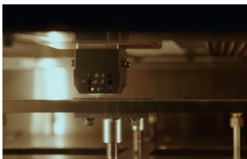
3D-печать подлокотника Ulmer StraBenbahn на принтере Fortus 900mc из термопластика Stratasys, соответствующего стандартам устойчивости к пламени, дыму и уровню токсичности
