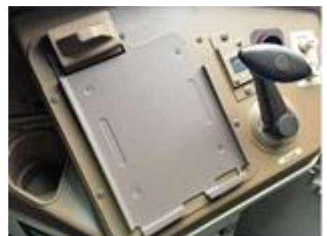
Разработанные Eastern Airlines Technic держатели для электронных планшетов пилотов, напечатанные на 3D-принтере в лаборатории
