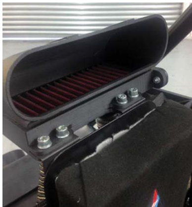
Корпус вентилятора охлаждения из термопластика Ultem 9085
