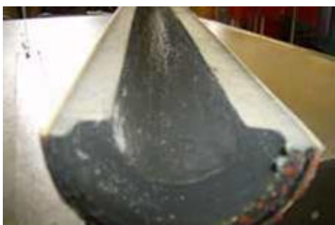
Разделенный на части заряд топлива, изготовленный из ABS после 10 секунд работы двигателя. Отсутствуют признаки эрозионного горения, характерного для зарядов, отлитых традиционным способом из полибутадиена с концевыми гидроксильными группами (НТРВ)
