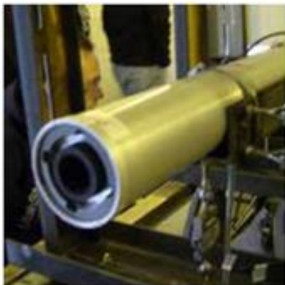
Ракетный двигатель D-DART™, установленный на испытательном стенде
