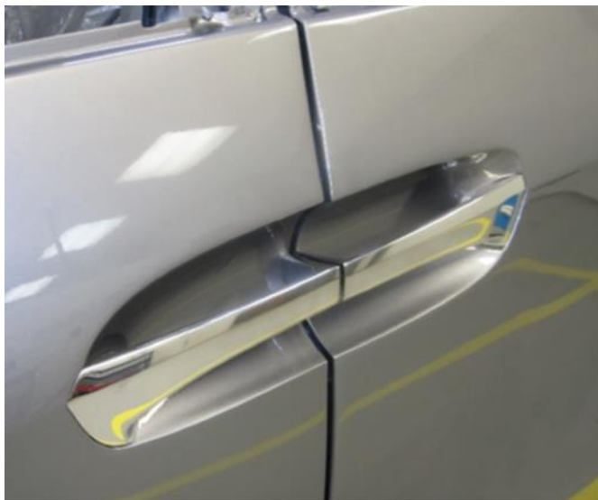
Окончательная версия прототипа, изготовленного на станке с ЧПУ и интегрированного в автомобиль
