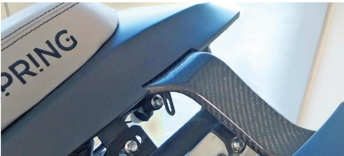
Задняя опора в конечном исполнении
