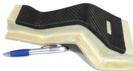
Созданный на 3D-принтере суппорт крыла мотоцикла
