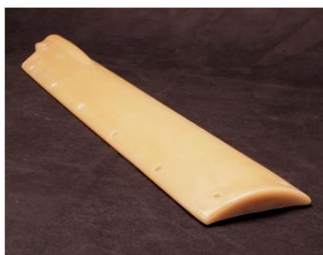
Литой уретановый внешний корпус, готовый к окончательной обработке, окраске и установке на катушку МРТ
