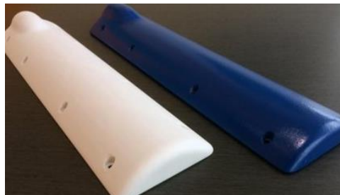
Внешний корпус FDM, который будет использоваться как мастер-форма: перед окончательной доработкой и окраской (слева) и после них (справа)
