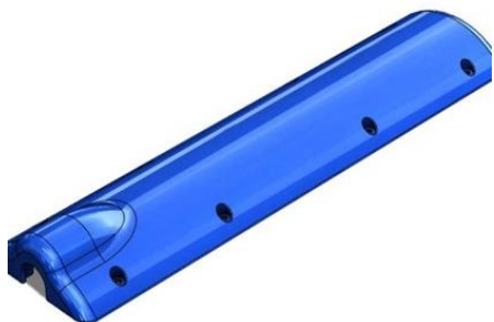
CAD-изображение кастомизированного корпуса катушки ScanMed, который будет использоваться как мастер-форма FDM для создания силиконовой формы
