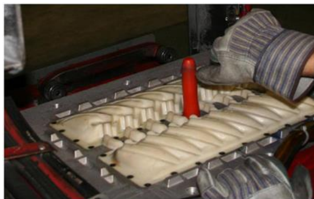
Модельная плита на формовочном станке
