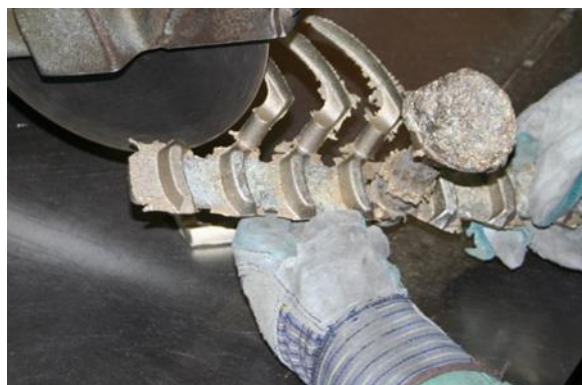
Отсекающие шиберы и стояки литой детали
