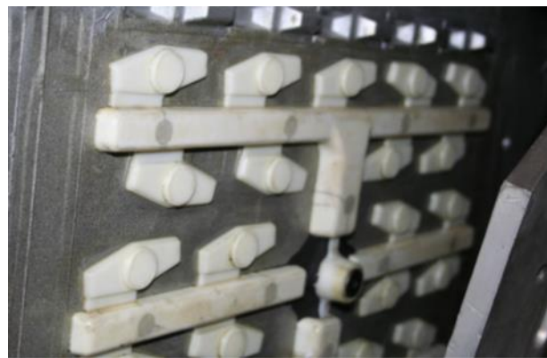
Разъемная модель FDM, прикрепленная к заготовке модельной плиты
