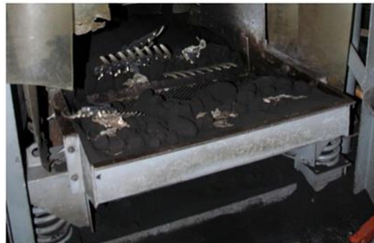
Удаление песка из отливки на выбивном столе
