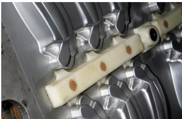
Модельная плита со взаимозаменяемой литниковой системой и системой канав
