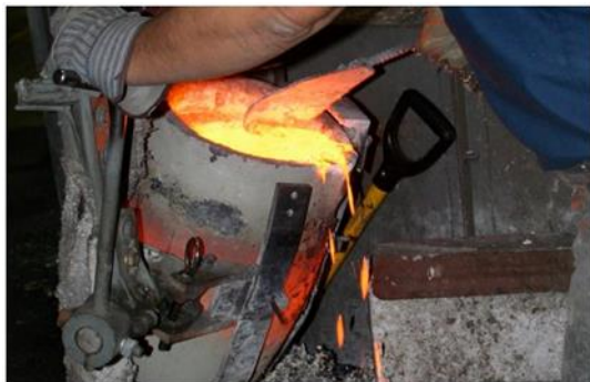
Заливка расплавленного металла
